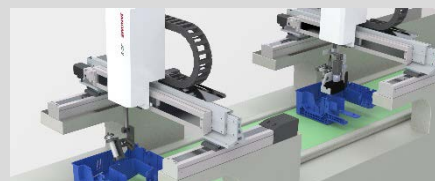
直交ロボットを利用した自動化設備例
