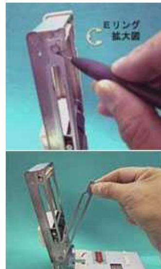
3. インクローラーの軸を指で引っ張り抜きます。
