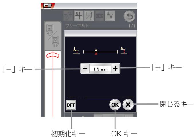
PD-H：フリーキルト押さえは、ぬい中最適な押さえ高さ（押さえの下面が布に軽く触れる位置）に自動セットされますが、QC：フリーキルト押さえ（丸穴）とQO：フリーキルト押さえ（前あき）、QV：フリーキルト押さえ（透明）の場合、布の種類や厚さによってはすきまがあいたり、強く押さえすぎたりする場合があります。その場合は押さえ高さの調節をしてください。
