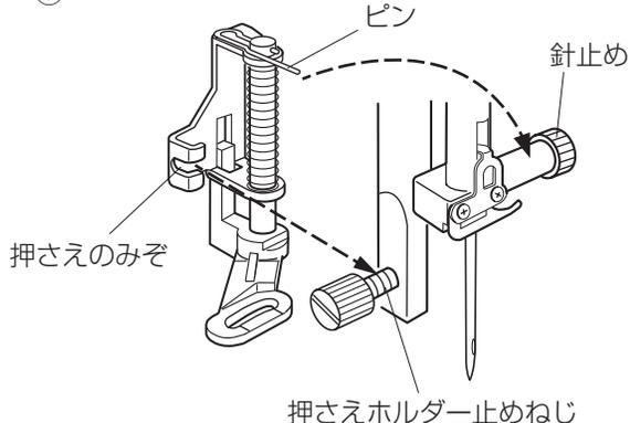
⑤ 針と押さえ上げがあがっている状態で、フリーキルト押さえのピンを針止めの上にのせ、押さえのみぞを、うしろ側から押さえホルダー止めねじに合わせ、押さえホルダー止めねじをドライバーでしっかりしめます。
