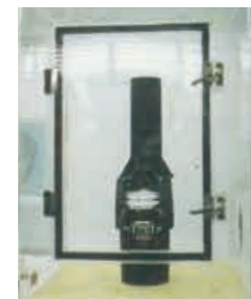
当社の注型装置で完成したX線反射望遠鏡のホットマルケース・フード。衛星「あすか」に搭載
