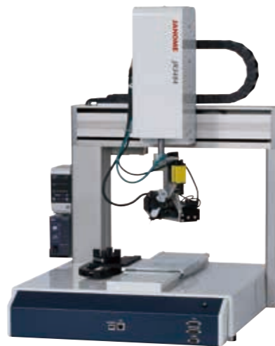
カメラ搭載塗布の4軸仕様
